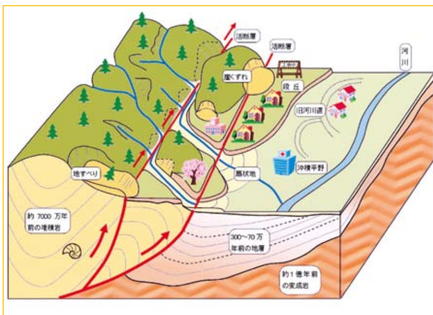
図-3 中央構造線周辺の地形と地質断面の模式図
