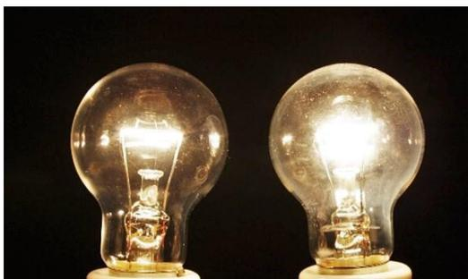
図5 点灯させた消費電力の異なる2つの電球
