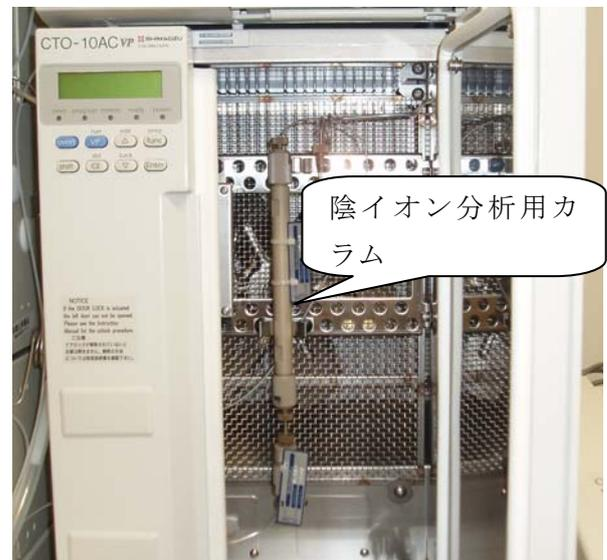
分配やイオン交換クロマトグラフィーでは温度の影響を大きく受ける。一般的にはカラム温度が上がればカラム効率が高くなる。そのため分離度を高くするため、カラム恒温槽を使用することが望まれる。
